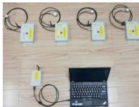
图 4 GIS 无线击穿定位系统
